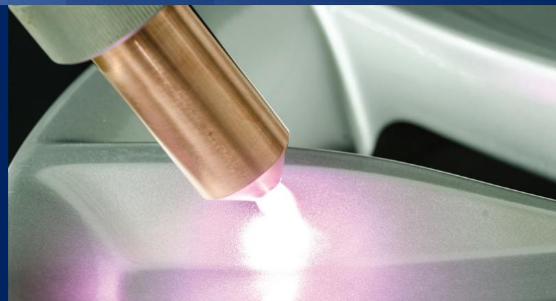
À la sortie du nez de la buse, la décharge du jet plasma étant concentrée et peu conductrice électriquement, ce procédé offre un **traitement de surfaces précis**, permettant de travailler dans le détail sur des **zones très ciblées, aussi bien sur des supports conducteurs qu'isolants mais également sur des pièces électroniques.**
