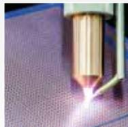
Particulièrement recommandé lorsqu'il s'agit d'embarquer des buses sur des robots pour le traitement de largeurs relativement étroites et/ou présentant des reliefs complexes. Solution également préconisée pour une activation combinée à la mise en température.
